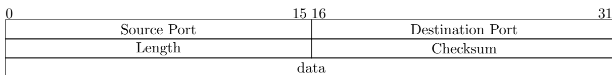
Abbildung 4.3.: User Datagram Protocol Header
